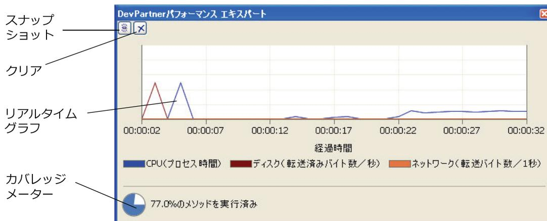
図 7-1 パフォーマンス エキスパート ウィンドウによるデータ収集の制御
